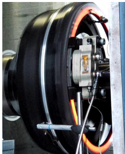
Рисунок 2 а, б. Мотор-колесо компании Protean: в неподвижном положении (а) и в процессе торможения (б).
