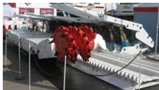
Рисунок 2. Вид очистного комбайна с БСП
