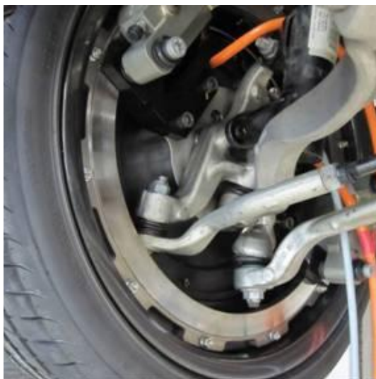
Рисунок 2 а, б. Мотор-колесо компании Protean: в неподвижном положении (а) и в процессе торможения (б).
